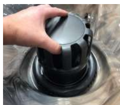
Ziehen Sie nach oben, um die Schwimmerbaugruppe zu entfernen
