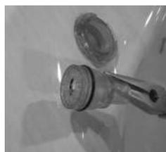
4. Nettoyez le diffuseur en plastique au dos de l'insert du jet ou l'ensemble de jet à écoulement laminaire de façon à débarrasser tous les trous de débris.
