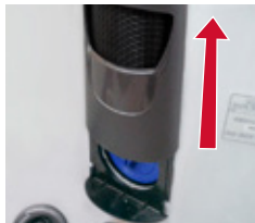
Blende zum Entfernen nach oben schieben
