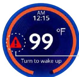
L'affichage d'un triangle rouge avec un point d'exclamation sur l'écran du mode veille indique qu'une erreur est active. Consultez le menu d'erreur sur l'écran principal pour en savoir plus. Si aucune erreur n'est détectée, aucune icône n'est affichée sur l'écran principal.
