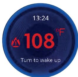
Wird ein Übertemperatur-Fehler erkannt, erscheint auf dem Hauptbildschirm ein rotes Flammendreieck mit Ausrufezeichen. Dieser Fehler tritt auf, wenn die Wassertemperatur 42 °C (108 °F) beträgt oder höher ist. Der Whirlpool darf bei diesem Fehler nicht betreten werden.
