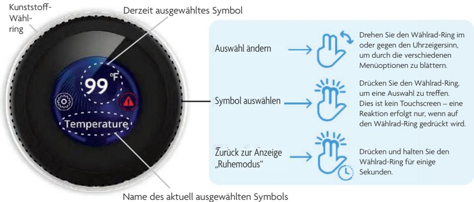
Das Wählrad ermöglicht den Zugriff auf verschiedene Informationen und Menüs. Dazu gehören die Gerätesteuerung und die Wassertemperatur sowie Optionen wie Einstellungsmenüs, Wasserpflege-Anpassung, Nachrichten und Warnhinweise. Durch Drehen des Wählrad-Rings im oder gegen den Uhrzeigersinn blättern Sie durch die verschiedenen Menüoptionen.
