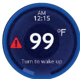
Wenn die eingestellte Wassertemperatur niedriger ist als die aktuelle Wassertemperatur, ist ein blauer Anzegebogen zu sehen. Der blaue Anzegebogen zeigt an, dass sich das Wasser auf die eingestellte Temperatur abkühlt. Die Länge des Anzegebogens stellt die Temperaturdifferenz zwischen der aktuellen Wassertemperatur und dem eingestellten Wert dar. Er wird allmählich kürzer, bis die eingestellte Temperatur erreicht ist.
