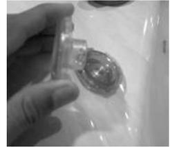
3. Wenn nur die Laminar Flow-Düsenbaugruppe herauspringt: Spülen Sie sie aus und überprüfen Sie sie. Oder falls sich nur der äußere Ring ablöst: Entfernen Sie die inneren Düseneinlagen mit einer Nadelzange und überprüfen Sie sie.
