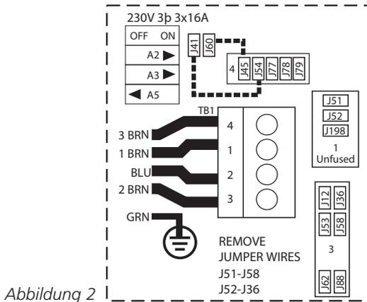
\*Die Verkabelung muss den Spa-Spezifikationen entsprechen. Die maximale Nennstrombelastbarkeit des Whirlpools darf die maximale Strombelastbarkeit des Betriebs nicht überschreiten. Dies stellt keine Option für den Installer dar. Siehe Seite „Modellspezifikationen“ für elektrische Anforderungen nach Spa-Modell.
