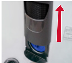
Blende zum Entfernen nach oben schieben
