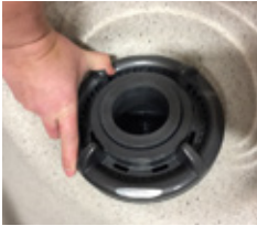
Verschlussring entgegen dem Uhrzeigersinn drehen, um den Schwimmer zu entfernen
