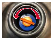
Tourner les filtres dans le sens antihoraire pour les retirer
