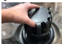
Tirez vers le haut pour retirer l'assemblage flottant
