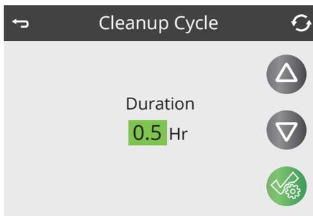
**HINWEIS:** Reinigungszyklen sind nicht bei Systemen verfügbar, die auf einen 24-Stunden-Umwälzpumpenmodus eingestellt sind, da die Umwälzpumpe als Heizgerät fungiert und die Filterpumpe konstant filtert.
