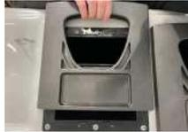
Lassen Sie den Überlaufeingang Richtung Filter zurückfallen, wenn Sie das Filtergehäuse entfernen.
