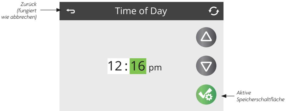
Wenn Sie sowohl die Schaltfläche Back und eine Schaltfläche Active Save sehen, wird die Save-Schaltfläche speichern und sich die grüne Auswahl in weiß ändern, während die Back-Schaltfläche den Vorgang abbrechen wird. Wenn sich der Bildschirm aufgrund von Nichtaktivität abschaltet, kommt dies einem Abbruch gleich.
