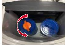
Drehen Sie die Filter entgegen dem Uhrzeigersinn um sie zu entfernen
