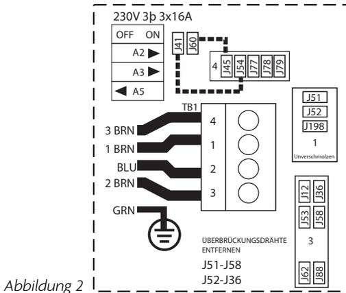
\*Verdrahtung muss auf Swimming-Whirlpool-Spezifikation angepasst werden. Die maximal zulässige Stromstärke des Swimming-Whirlpools darf die maximale Stromstärke der Leitung nicht übersteigen. Für den Installateur ist dies keine Option. Siehe Modellspezifikationsseite für elektrische Anforderungen des Whirlpool-Modells.
