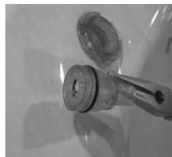
4. Reinigen Sie den Luftverteiler auf der Rückseite der Düseneinlage oder der Laminar Flow-Düsenbaugruppe, so dass alle Löcher frei von Verunreinigungen sind.
