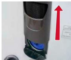
Blende zum Entfernen nach oben schieben
