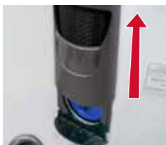
Faites glisser la façade vers le haut pour la retirer
