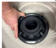
Anneau de verrouillage de torsion dans le sens antihoraire pour retirer l'assemblage flottant
