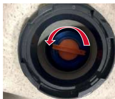
Tourner les filtres dans le sens antihoraire pour les retirer
