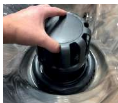
Tirez vers le haut pour retirer l'assemblage flottant
