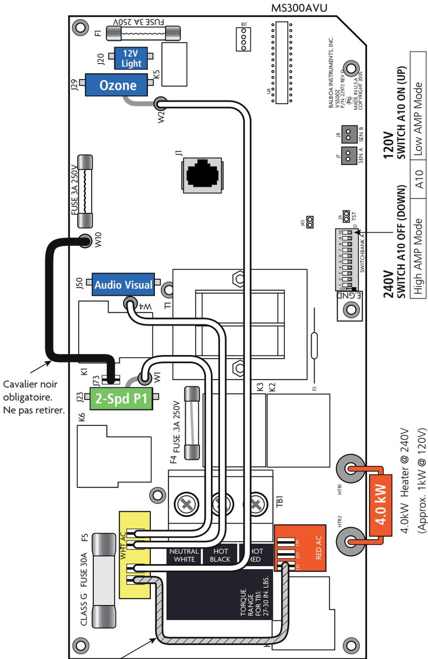
Ce cavalier doit être ajouté pour l'option d'alimentation 120 V et le DIP A10 doit être activé. Retirez le cavalier pour le branchement 240 V.
