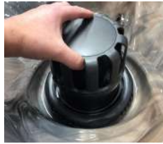
Ziehen Sie nach oben, um die Schwimmerbaugruppe zu entfernen
