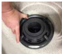
Faites tourner l'anneau de blocage dans le sens antihoraire pour extraire le flotteur
